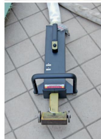
all'interno di una guaina in cui scorre acqua (10 litri al minuto a una pressione di 4 bar) per raffreddarli costantemente e consentire un utilizzo continuo. La parte elettrica è trifase a 380 volts (ma può arrivare fino a 500 volts), 125 ampere, e 50 o 60 hertz di frequenza. La macchina richiede un livello molto basso di manutenzione, e i pezzi di ricambio, grazie alla relativa vicinanza con la casa madre, sono forniti da 2A Engineering in tempi brevi.
